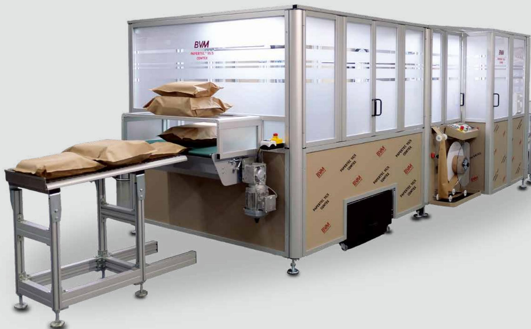
Die vollautomatisch in Linie arbeitende Maschine **Papertec® 95/5 Comtex** kann innerhalb ihres Formatbereichs unterschiedliche und im Wechsel ankommende Produkte verarbeiten. Diese müssen nicht vorsortiert werden und können in ihren Abmessungen variieren.
